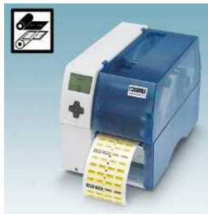
Термопечатающий принтер для рулонов THERMOMARK X1.2 Стр. 40
