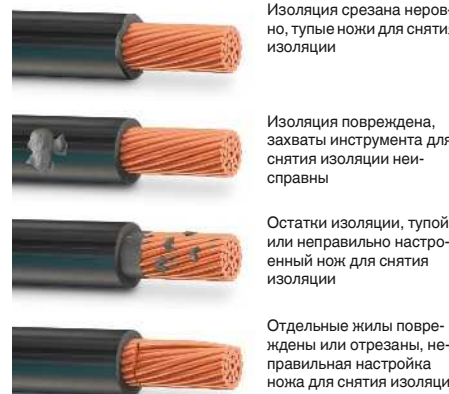
Ошибки снятия изоляции по DIN МЭК 60352
